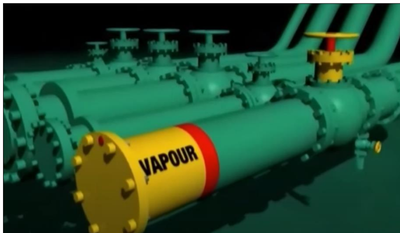
Figura 13. Manifold de control de vapor.
