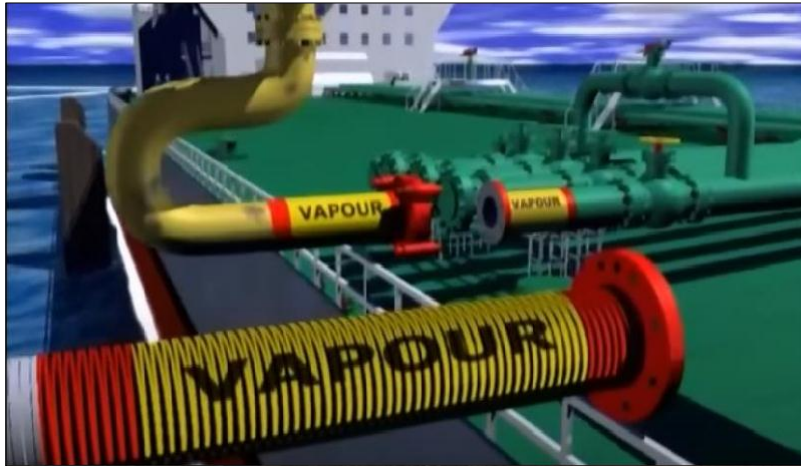
Figura 14. Líneas del sistema de recuperación de vapores a bordo del buque. Fuente: Recuperado de https://www.youtube.com/
