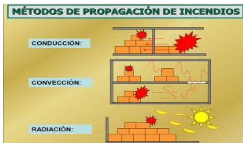
Figura 12. Métodos de propagación de incendios.
