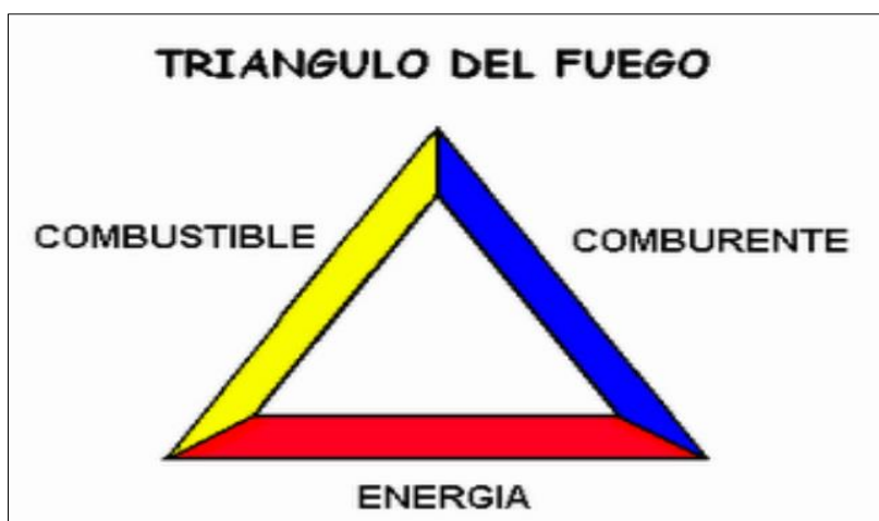
Figura 9. Triángulo del fuego.
