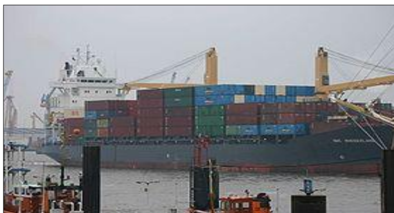
Figura 19. Grúas de Buque.
