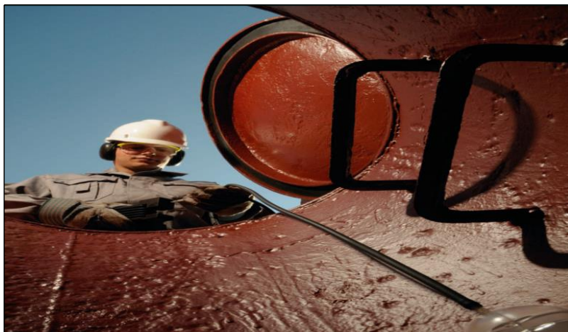
Figura 12. Los ensayos de la atmósfera de un espacio cerrado es una actividad necesaria antes de su ingreso.
