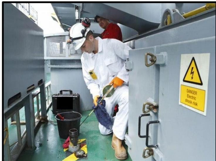
**Figura 7.** Sondeo de tanques para el cálculo del combustible.
