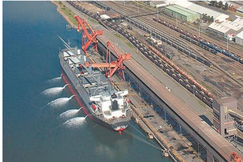
Figura 2: Buque en operación de deslastre amarrado a muelle
