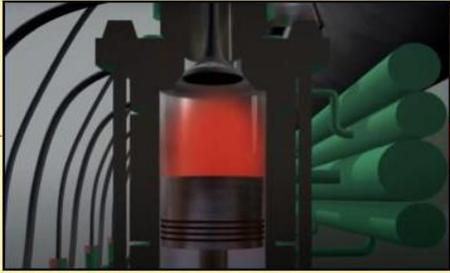
Compresión del pistón en la cámara de combustión.
