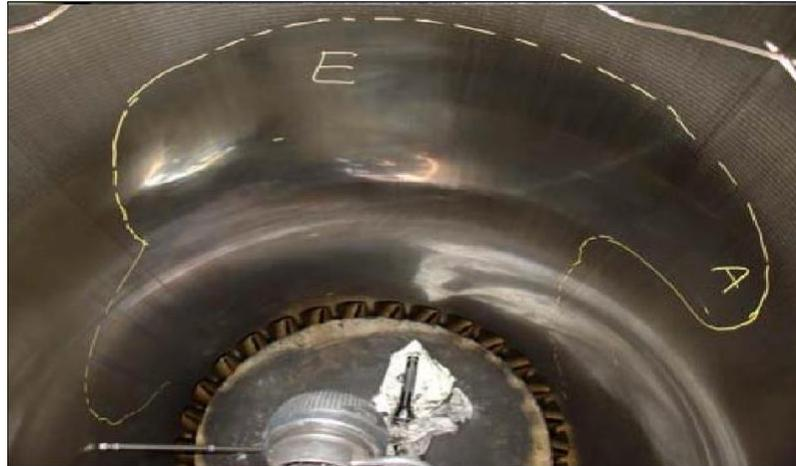
*Nota.* Pulido en la camisa por ruptura de la película de lubricación debido a la neutralización de todos los ácidos. (Consejo Internacional de Motores de Combustión Interna, Directrices para la lubricación de motores diésel: Impacto en la lubricación de motores marinos que utilizan combustible con bajo contenido de azufre, 2007, p. 9)
