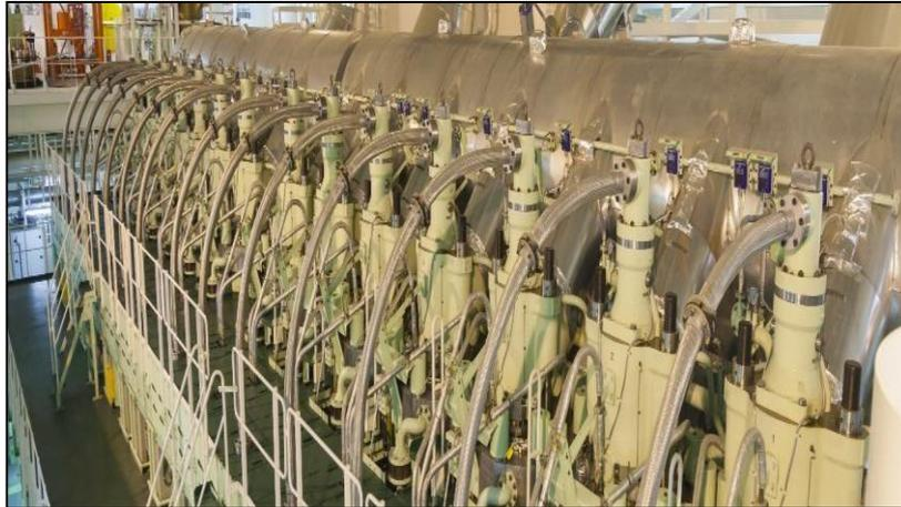
*Nota.* Los motores de 2 tiempos presentan 2 sistemas de lubricación, uno para el pistón y el cilindro y otro para las piezas móviles del sistema. (<https://www.repsol.com/es/productos-y-servicios/lubricantes/marinos/2t/index.cshtml>)
