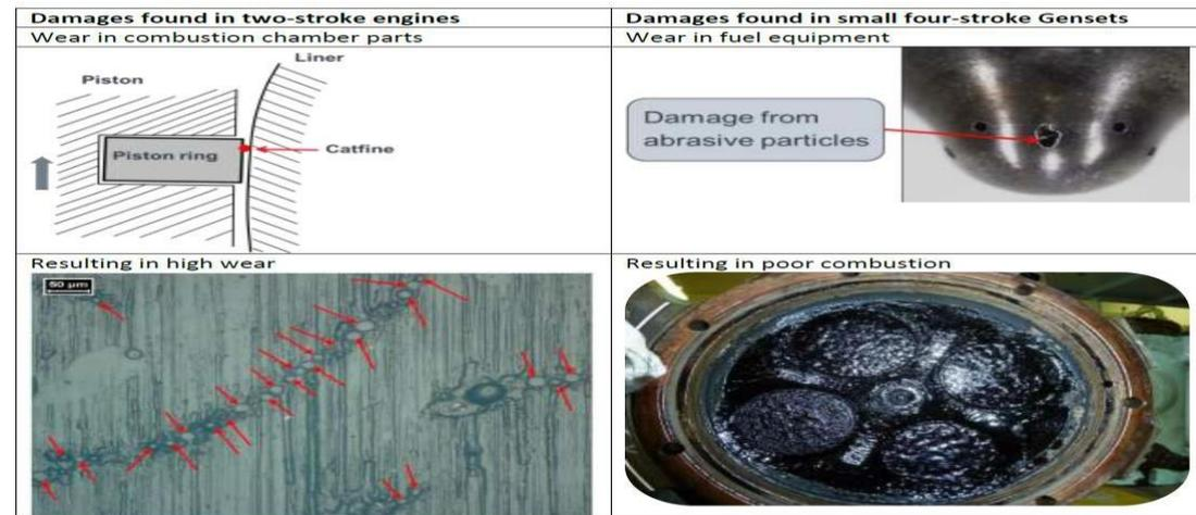
*Nota.* Los finos catalíticos causan daños abrasivos en la camisa del cilindro y anillos del pistón (Finos catalíticos: Impacto en el desgaste del motor y cómo reducir el desgaste, MAN Diesel & Turbo, 2017, p. 5).
