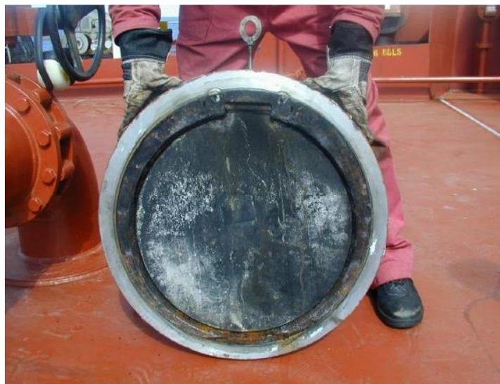
*Figura 10.* Válvula de no retorno de Gas Inerte
