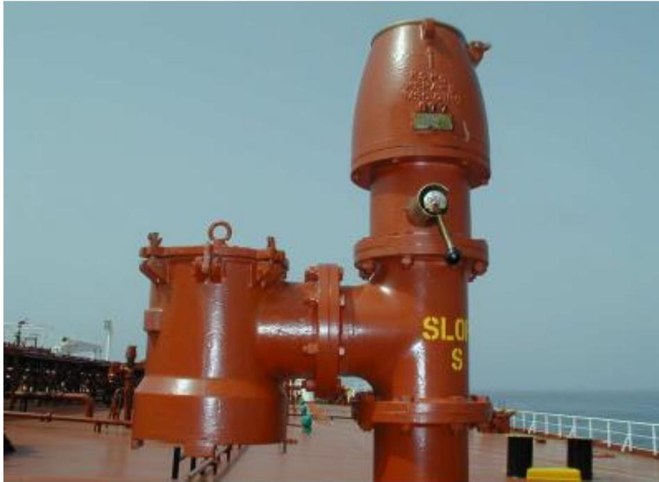
*Figura 6.* Válvula P/V presión vacío
