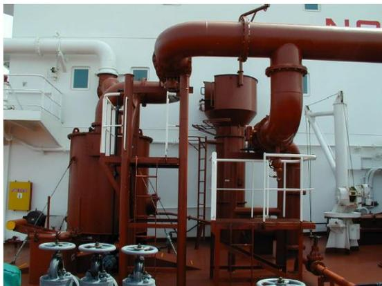
*Figura 14.* Sello, válvula no retorno y válvula manual (mil vueltas)
