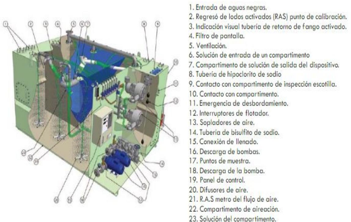
*Figura 4.* Despiece isométrico de una Planta de Tratamiento para buques mercantes
