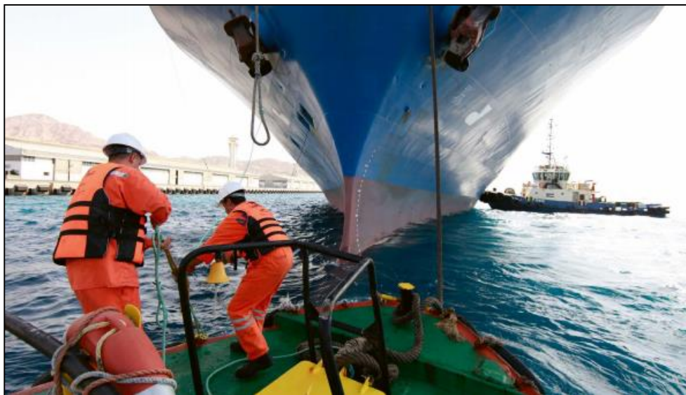
Figura 5. Operaciones de navegación en aguas confinadas asistida por remolcadores. Fuente: SAFETY4SEA (2020).
