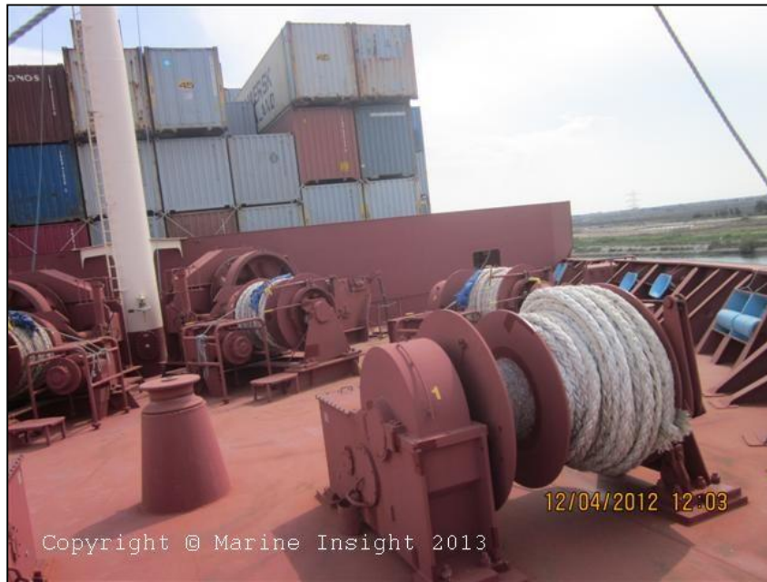
Figura 7. Área de amarre de un buque. Fuente: Bhattacharjee (2019, en: Marine Insight).
