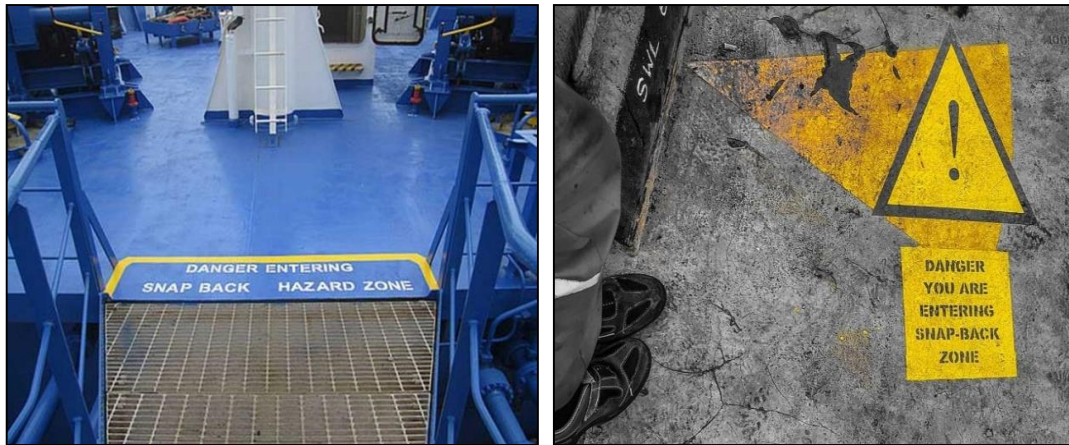
Figura 9. Ejemplos de indicaciones de zonas de retroceso en la cubierta de los barcos. Fuente: Bhattacharjee (2019).
