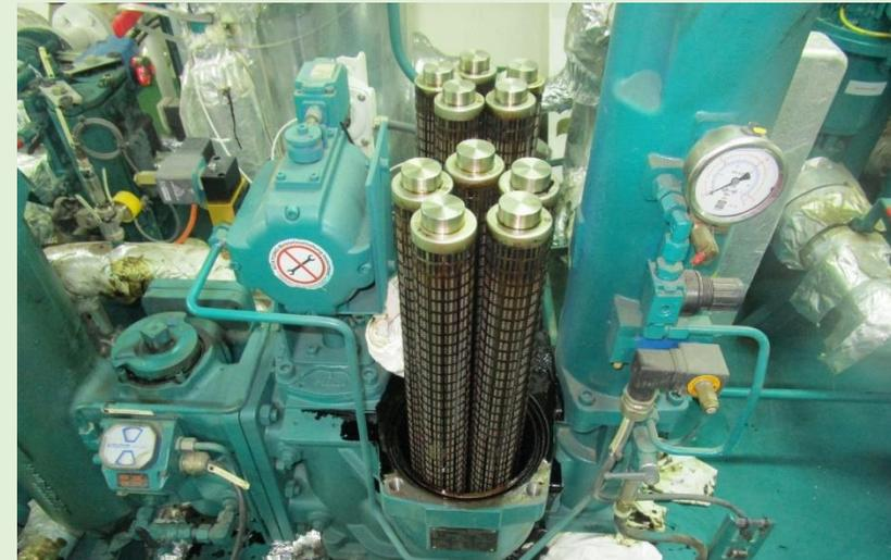
Interpretación: Se observaron diferentes anomalías relacionadas con el sistema de combustible, específicamente los sistemas de filtros, retención y separación de impurezas, lo cual indicaba baja calidad del combustible y poca eficiencia en la purificación. Ante dicha situación se activaron las alarmas correspondientes de los filtros del sistema de alimentación de combustible.
