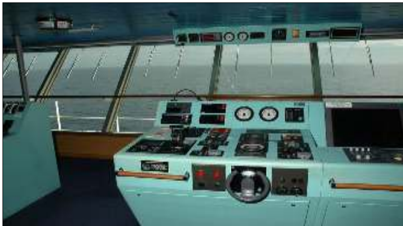
Figura 10. Control de dirección avanzado del timón de un buque.
