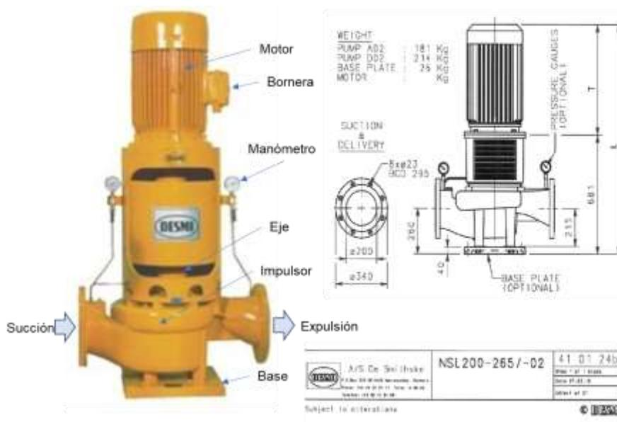
**Figura 10.** Bomba de retrolavado del sistema de gestión de agua de lastre “Ocean Guard”.
