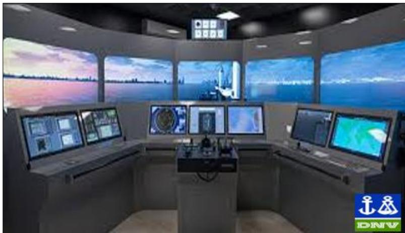
Figura 4. Simulador de navegación *“Full Misión Simulator”* clase A (NAV) de acuerdo a lo establecido por la clasificadora DNV.
