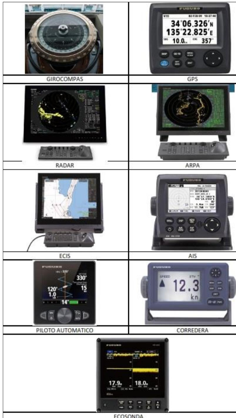
Figura 6. Principales equipos electrónicos de navegación.
