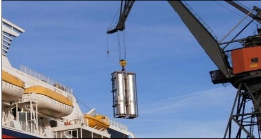
*Figura 5.* Torres de lavado trasladados a un buque para ser utilizados en cumplimiento con la norma OMI 2020.
