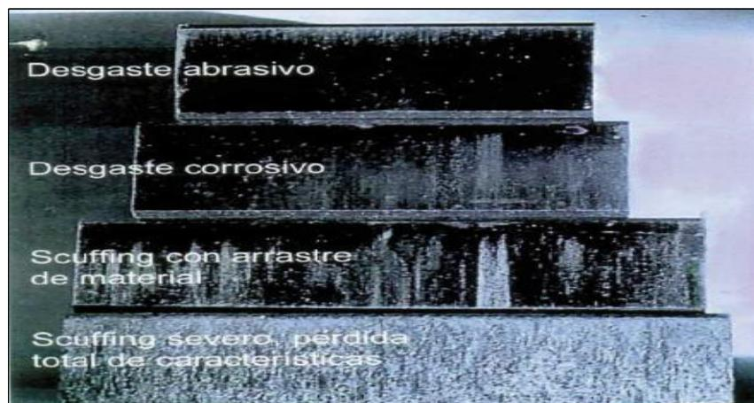
*Figura 4.* Porciones de aros de pistón con diferentes tipos de desgastes.
