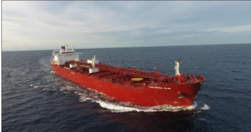
*Figura 6.* Takaroa Sun, buque tanque que utiliza el metanol como combustible marino.
