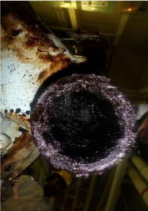
Figura 36. Exceso de lodos en el interior de las tuberías debido a la tendencia de formación de lodos.
