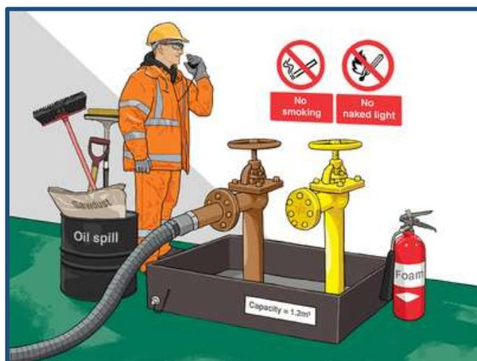
Figura 19. Bunker station con los equipos de SOPEP
