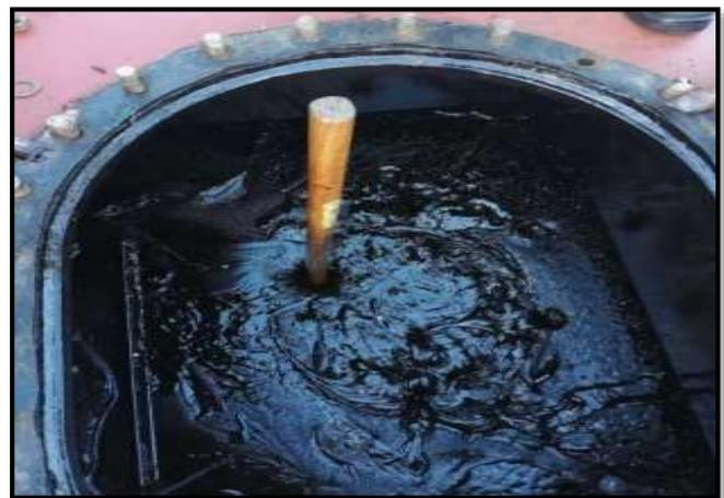
Figura 20. Tanque con combustible que alcanzo el punto límite de fluidez
