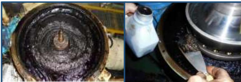
Figura 7. Parte interna del purificador con alta formación de lodos
