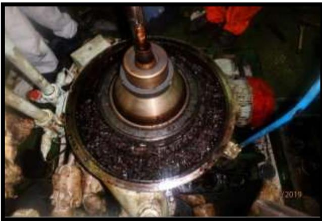
Figura 35. Exceso de lodos en la estructura interna del purificador debido a la tendencia de formación de lodos.
