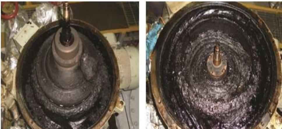
Figura 18. Formación de lodos y obstrucción
