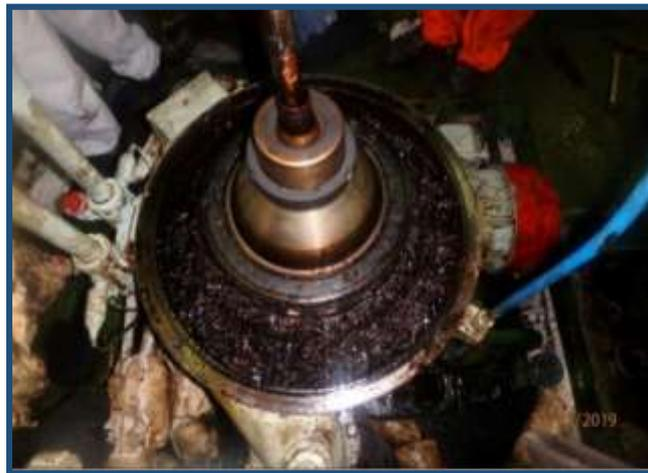
Figura 22. Exceso de formación de impurezas en un purificador
