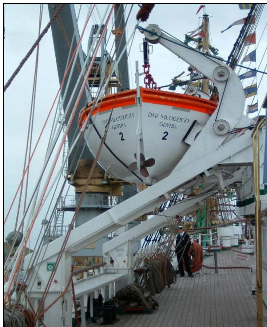
Figura 7. Botes Salvavidas Pescante de tipo Miranda o de gravedad mediante rieles.
