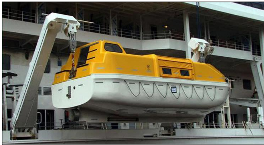
Figura 8. Botes Salvavidas Pescante por gravedad pivotante.
