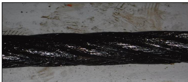
Figura 16. Alambre bien engrasado, para su prevención de la oxidación.
