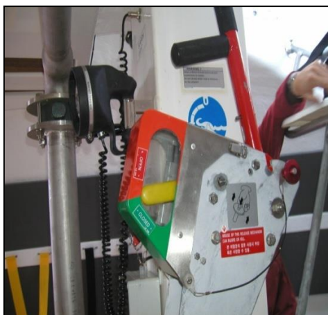
Figura 15. Palanca de liberación de los ganchos con criterio de colores.
