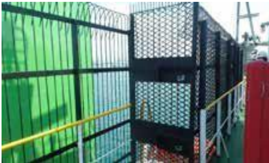
Figura 14. Acceso restringido a la acomodación Fuente. Publicación “BMP5”
