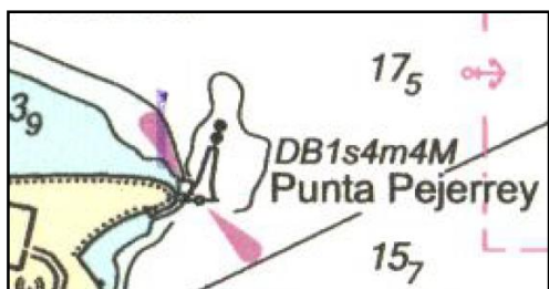
Figura 18. Boya de peligro aislado del puerto de Pisco representada en la carta.
