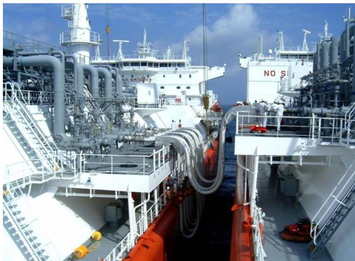
*Figura 02.* “Operación entre de aligeramiento dos buques utilizando mangueras como de LNG criogénicas transferencia conectadas los elemento manifolds”.
