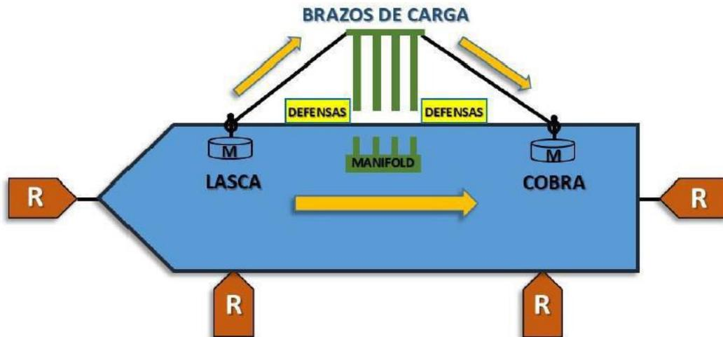
Figura 08. Esquema de sistema de coincide con la de propulsión, remolcadores lascar y cobrar esfuerzos combinados de las maquinillas para y permitir que la posición de los brazos colocar y acción del buque en posición de carga manifold.
