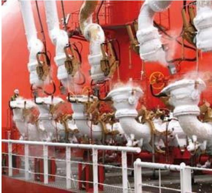
*Figura 04.* Sistema de los brazos de, desconexión de acoplamiento PERC en acción inmediata carga del buque manifold.
