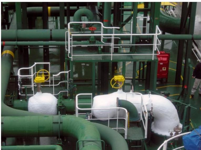
*Figura 11.* Enfriamiento formación. Se aprecia la de las líneas en cubierta de escarcha.
