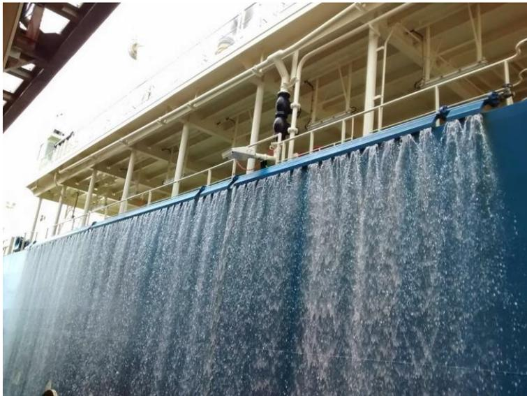
*Figura 10.* Cortina de agua en funcionamiento.
