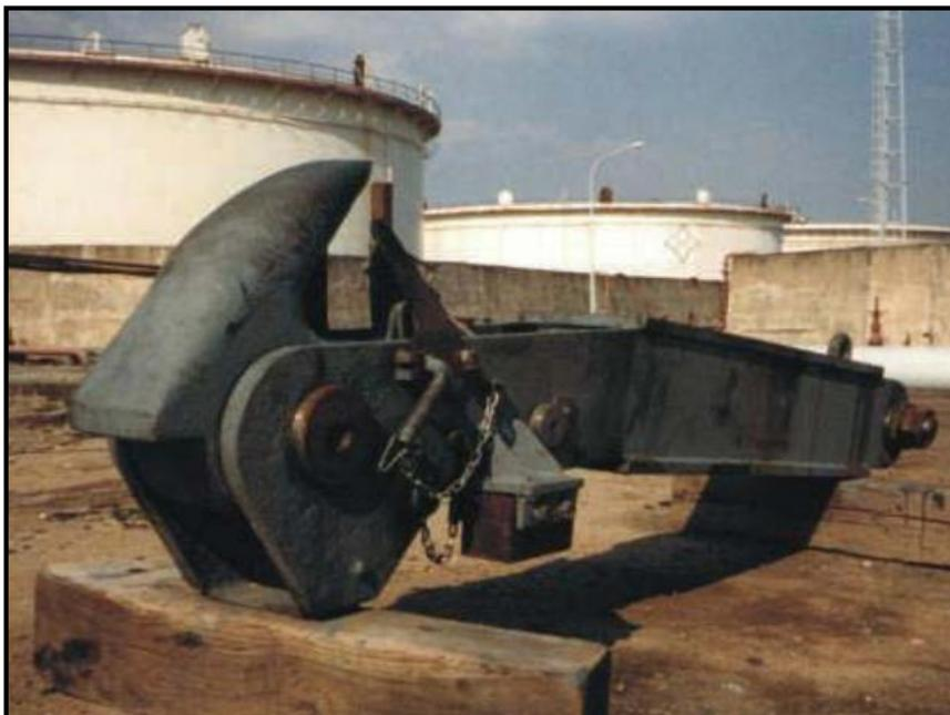
*Figura 35. Sistema mecánico de enganche y desenganche*
