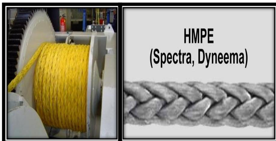
Figura10: Cabo de polietileno de alto módulo (HMPE) disponibles en las marcas de Spectra y Dyneema
