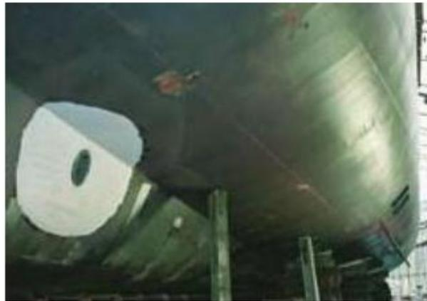
*Figura 18:* Detalle de instalación ánodo de referencia.
