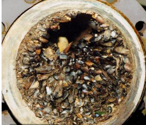
*Figura 24:* Acumulación de crecimiento marino en tuberías
