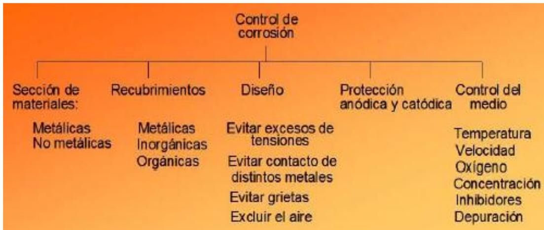
Figura 9. Métodos comunes de control de corrosión.
