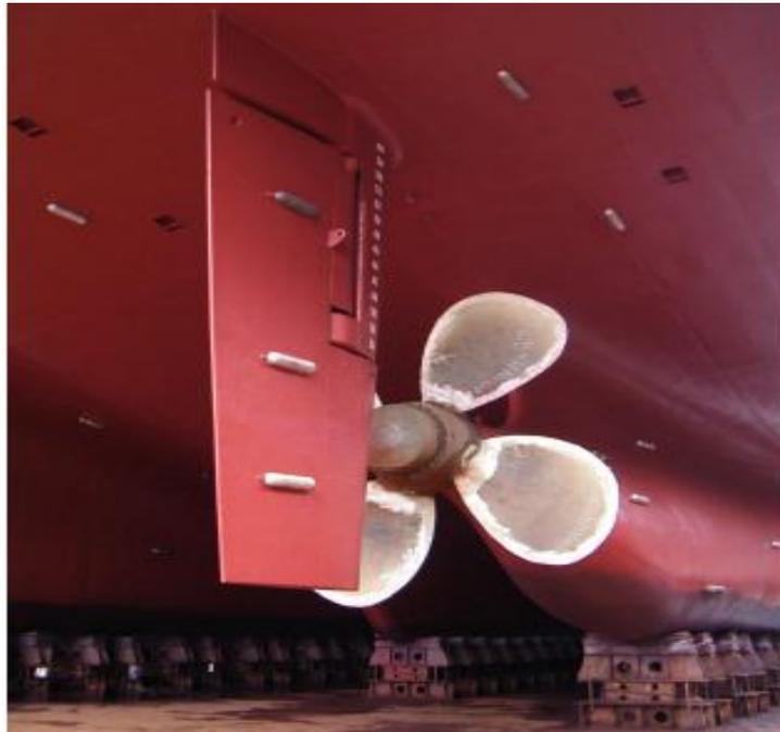
*Figura 23:* Ánodos instalados en el casco del buque
