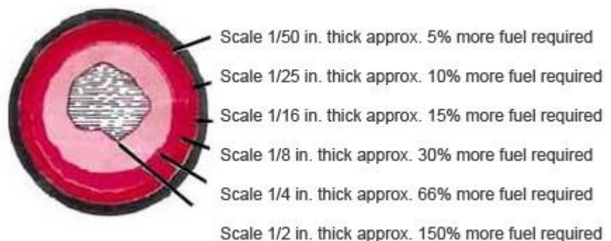
Figura 9. Requerimiento adicional de combustible debido al Scaling.
