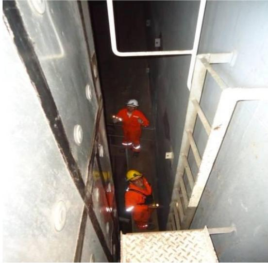
*Figura 7: Limpieza del tanque de agua de lastre*
