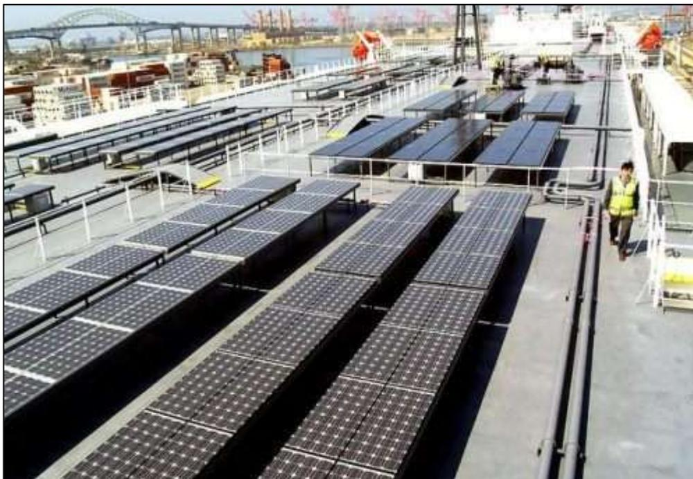
Figura 3. Vista cercana de los paneles solares sobre la cubierta del buque Auriga Leader
