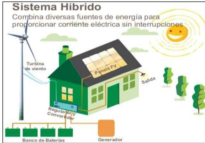
Figura 12. Esquema del sistema fotovoltaico híbrido
