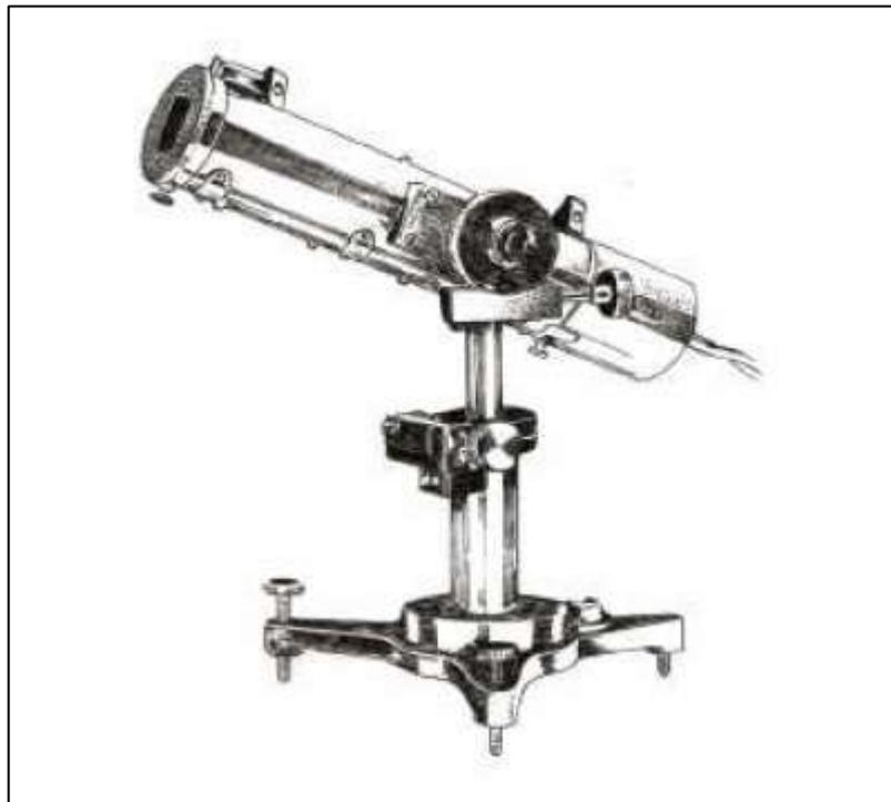
Figura 33. Pirheliómetro de compensación Angstrom
