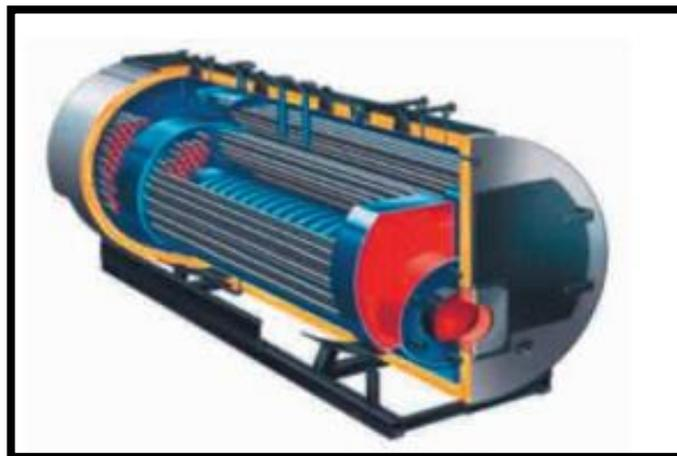
Figura 51: Detalles de caldera piro-tubular horizontal.
