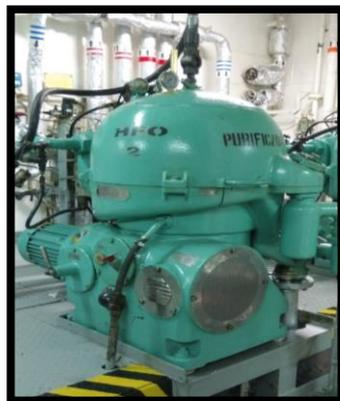
Figura 50: Purificador centrífugo B/T Nasca.
