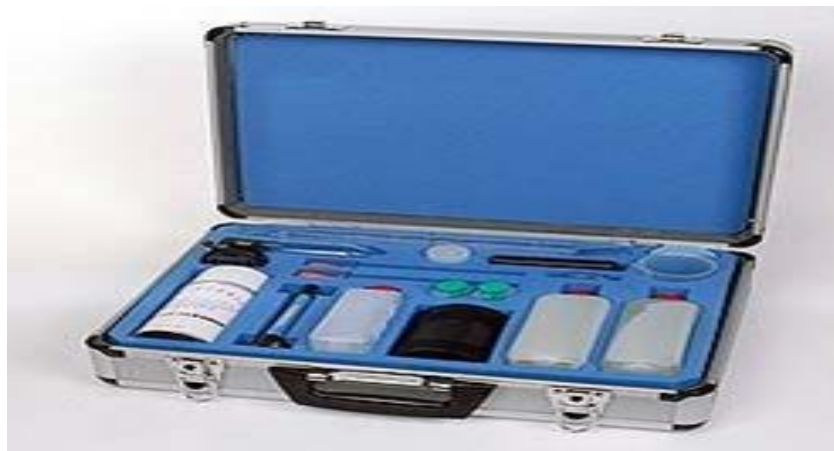
Figura 17. Kit de análisis de aceite de caldera térmica
