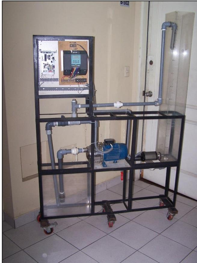
*Figura 32.* Foto de la maqueta del sistema de lastre
