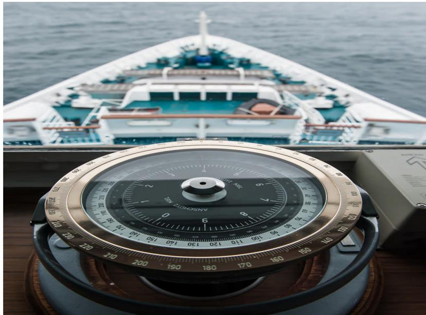
*Figura 30. Repetidor de Girocompás*
